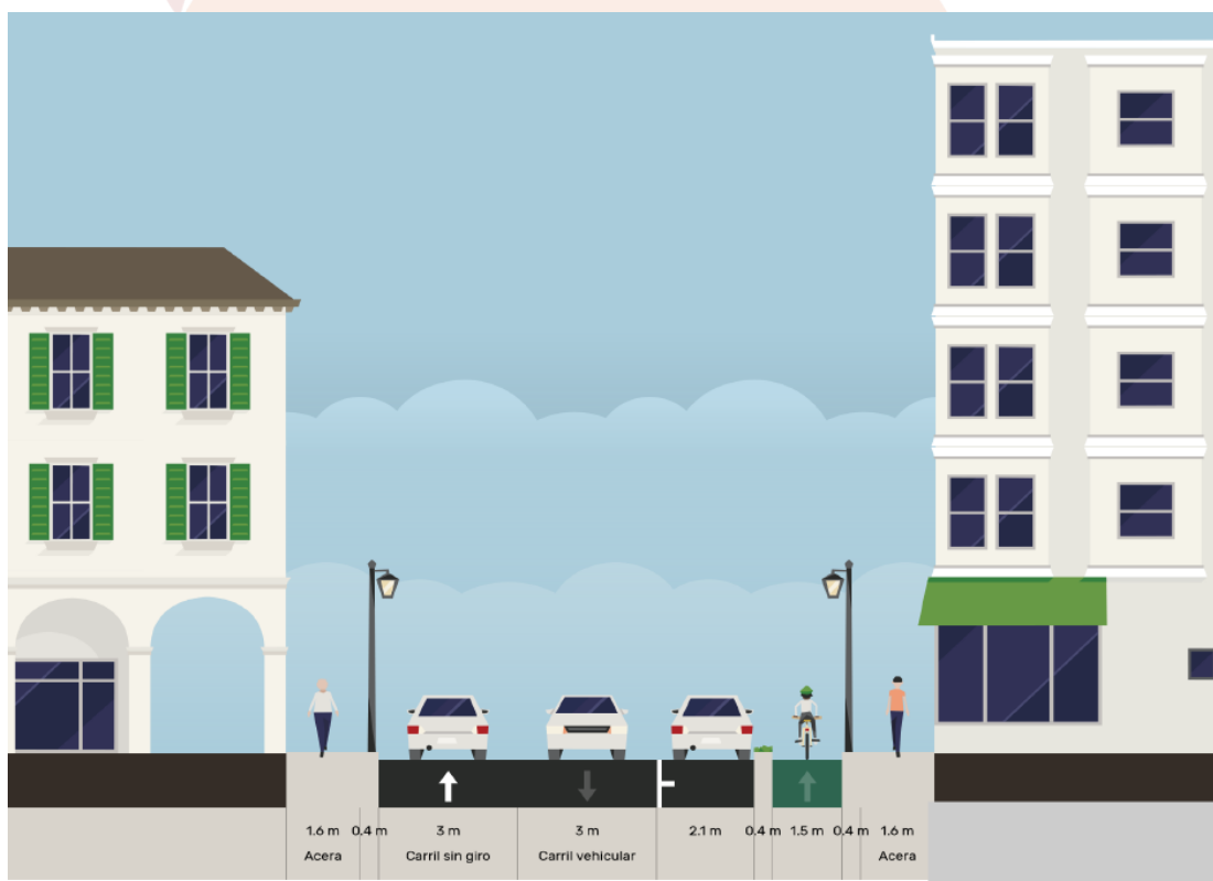
Imagen 185 Esquema de sección de la Av. Siglo XX
