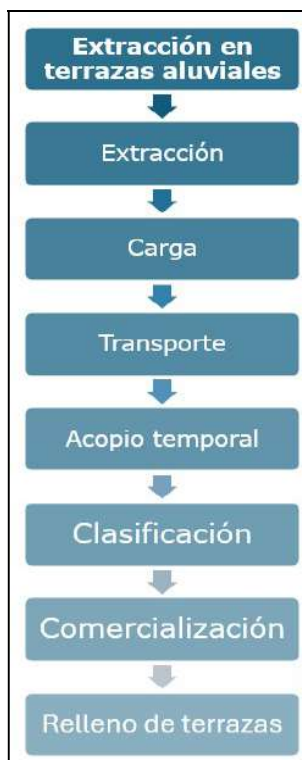
Diagrama 2: Diagrama de flujo de proceso operativo terrazas aluviales
